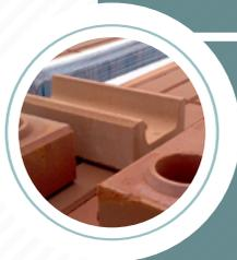
Muito se fala sobre os tijolos inteligentes, que são modulares e de fácil encaixe. O intuito é de que haja diminuição no consumo do cimento, sendo que para a estruturação dos tijolos não seria necessária essa matéria-prima.
