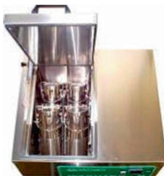
O *washtester* simula a lavagem caseira com sabão doméstico, agitações e temperatura ajustáveis conforme a delicadeza ou severidade que se queira atribuir ao ensaio.
