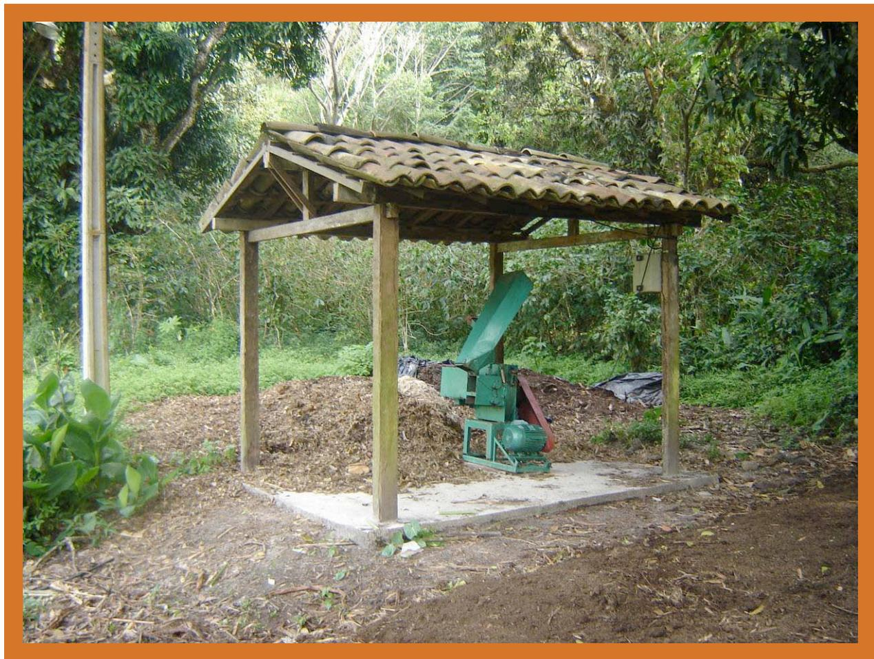
**ILUSTRAÇÃO 7. Triturador de matéria orgânica para o preparo de compostagem, sob proteção de telhado.**
