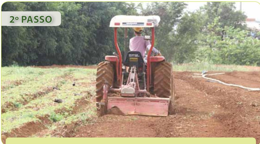
Levantamento de canteiros com rotoencanteirador acoplado ao trator
