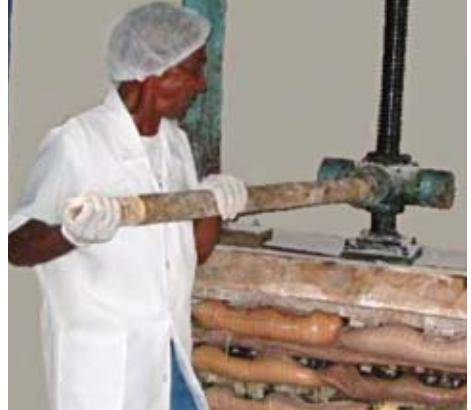
Figura 13 - Massa da mandioca sendo prensada para remover o excesso de água Fonte: Integra Consultoria
