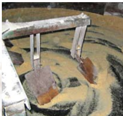
Figura 15 - Sistema de pás que impedem a farinha de “grudar” na chapa
