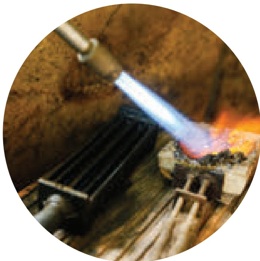
Fundição da prata com uma pequena quantidade de cobre, utilizando-se um maçarico. O resultado é uma prata mais dura e resistente aos arranhões.
