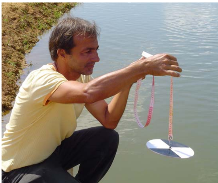
Figura 25 – Monitoramento da transparência da água.
